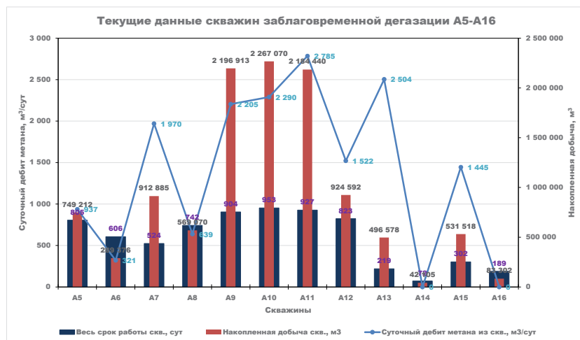
Результаты работы скважин заблаговременной дегазации на шахте «Ерунаковская-VIII»
