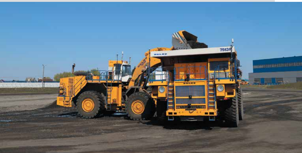
Испытания роботизированной техники БЕЛАЗ на полигоне предприятия
