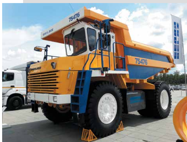
БЕЛАЗ-75476 грузоподъемностью 45 тонн с газопоршневым двигателем КУНГУР-550
